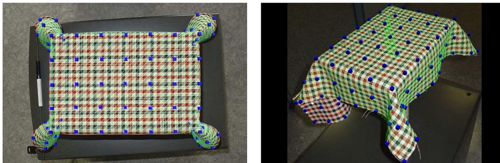
Figure 6.3 – Photographies du drapé réel avec la forme 3D reconstruite
