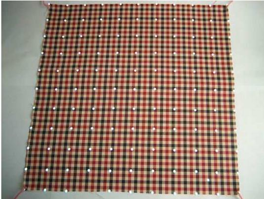
Figure 5.2 – Un morceau de tissu 50cm  $\times$  50cm avec les pastilles réfléchissantes
