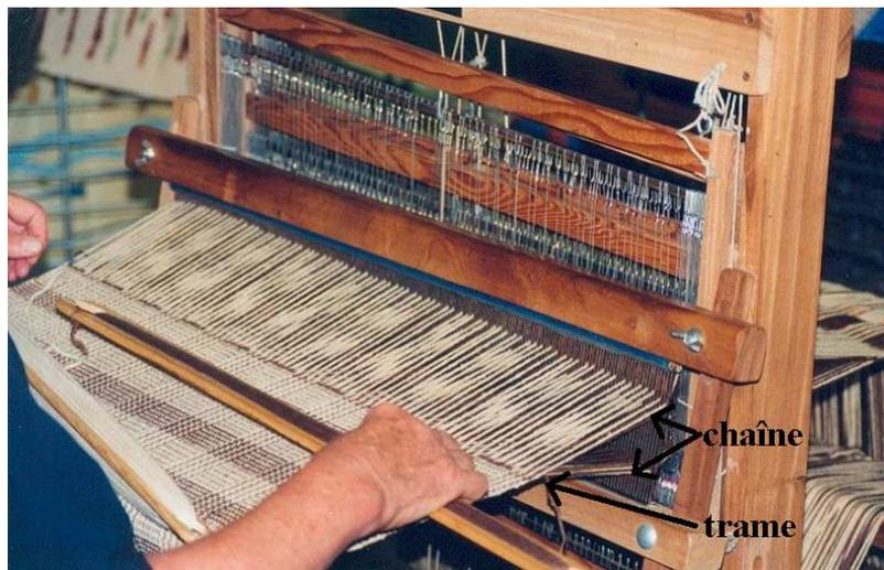
Figure 3.1 – Métier à tisser : les fils de chaîne sont séparés en deux couches (les "pris" en haut et les "laissés" en bas). Les fils de trame passent entre les pris et les laissés
