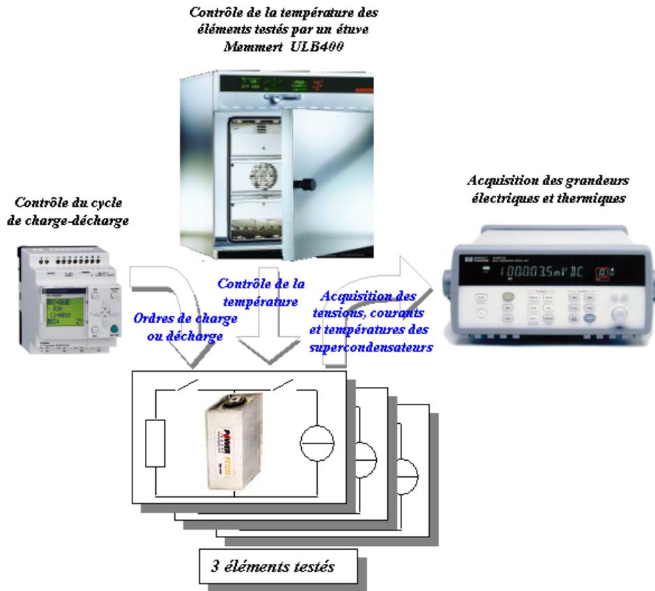
Fig. 4.19. : Synoptique du système de mesure
