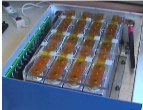
Fig. 3.3. : Module supercondensateur (96F, 56V, 400A)
