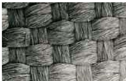
**Fig.1.5. : Structure microscopique d'un tissu activé**
