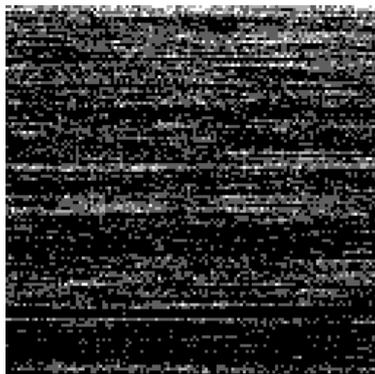
FIG. 3.17 – Détection au compteur de photons du passage des molécules de Rh6G en solution dans l'éthanol dans le volume sondé. La position du laser est fixée. L'"image" totale présentée comporte 128\*128 pixels dont l'intensité correspond au nombre de coups détectés en 1ms. L'analyse de cette "image" permet d'évaluer le taux présence des molécules dans le volume sondé.
