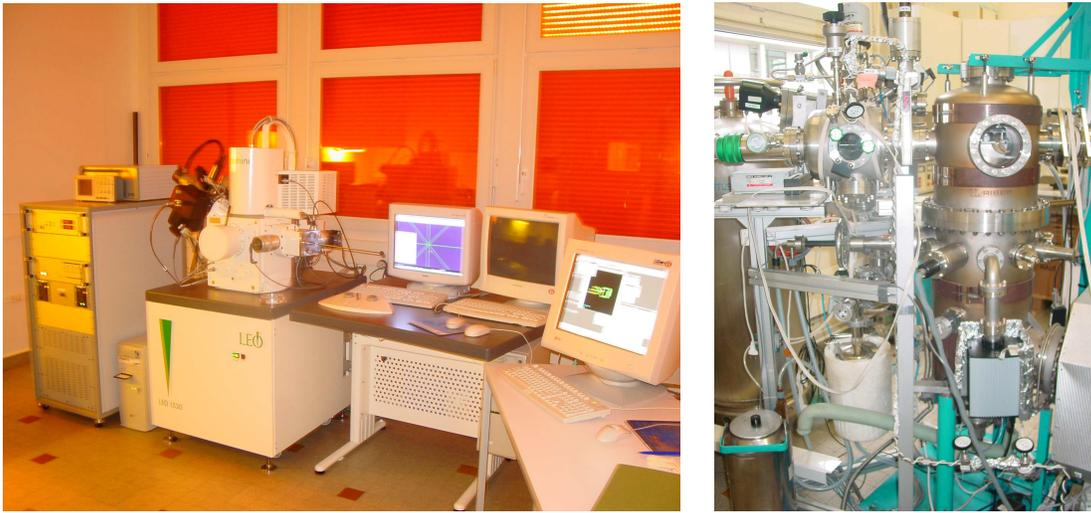
FIG. 2.1 – **À gauche** : le MEB et son électronique. **À droite** : le bâti de dépôt UHV.
