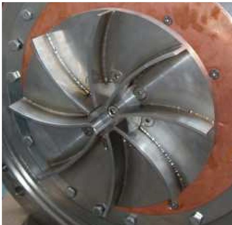
FIG. 1.6: *Photographie des turbines utilisées dans l'expérience VKS2 (TM73, voir tableau 1.1 pour leurs caractéristiques).*
