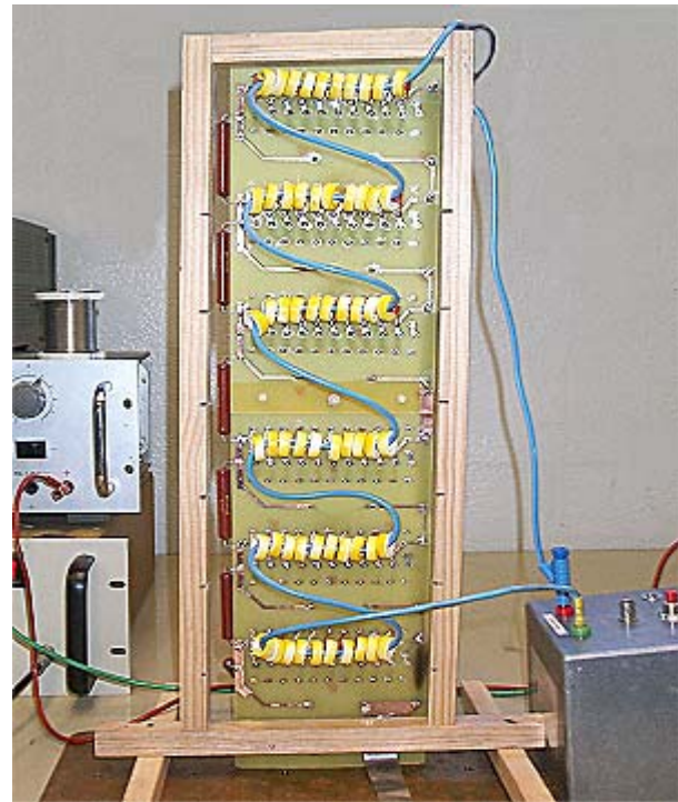
Figure 4-25 : Vue « côté commande » avec ferrites et circuit primaire de commande (réalisation à 6 étages)
