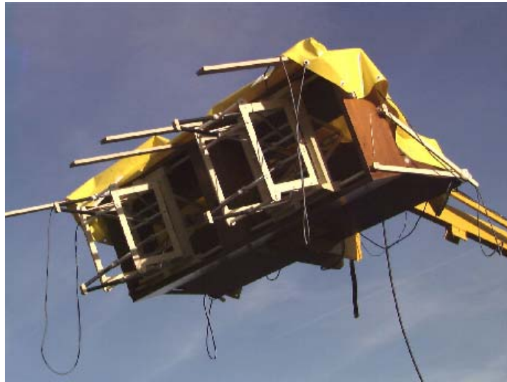
Figure 1-9 : Antennes ULB de type CISEAUX avec positionneur
