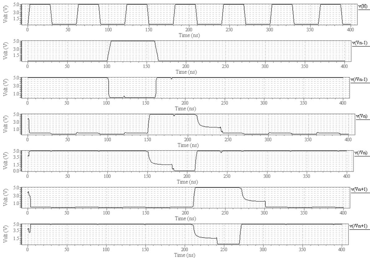
Figure 5-34: Simulation électrique de deux étages du registre à décalage avec une horloge de type CMOS.
