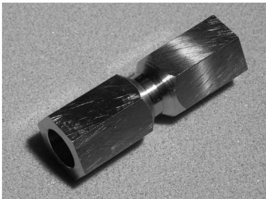
FIG. 6.2 - Photographie de l'éprouvette de torsion.
