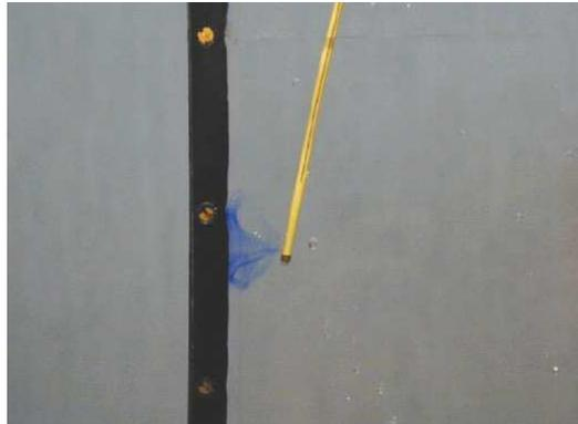
FIG. 2.10 – Cathéter équipé d'hydrojets [Ascari 03].
