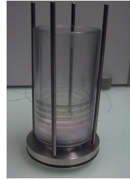
La cellule de mesure est transparente. A sa paroi intérieure sont collés deux fils en Kanthal. Les deux fils traversent ensuite ce tube pour sortir enfin du réacteur (Figure 2.4). Nous avons constaté un point de fragilité au niveau de la traversée du tube de poly-carbonate. Les fils en Kanthal ont rompu, peut-être par la corrosion.
