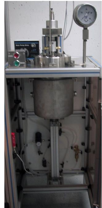
**Les pompes à engrenages** sont utilisées pour faire circuler des particules d'hydrates entre les deux réacteurs, ainsi que le fluide de réfrigérant circulant autour de la cellule de mesure. Ce sont des pompes Cole-Parmer équipées d'un variateur de vitesse de 50 à 5000 tr/mn. Le débit de cette pompe est de 2,5 à 5450 ml/mn.
