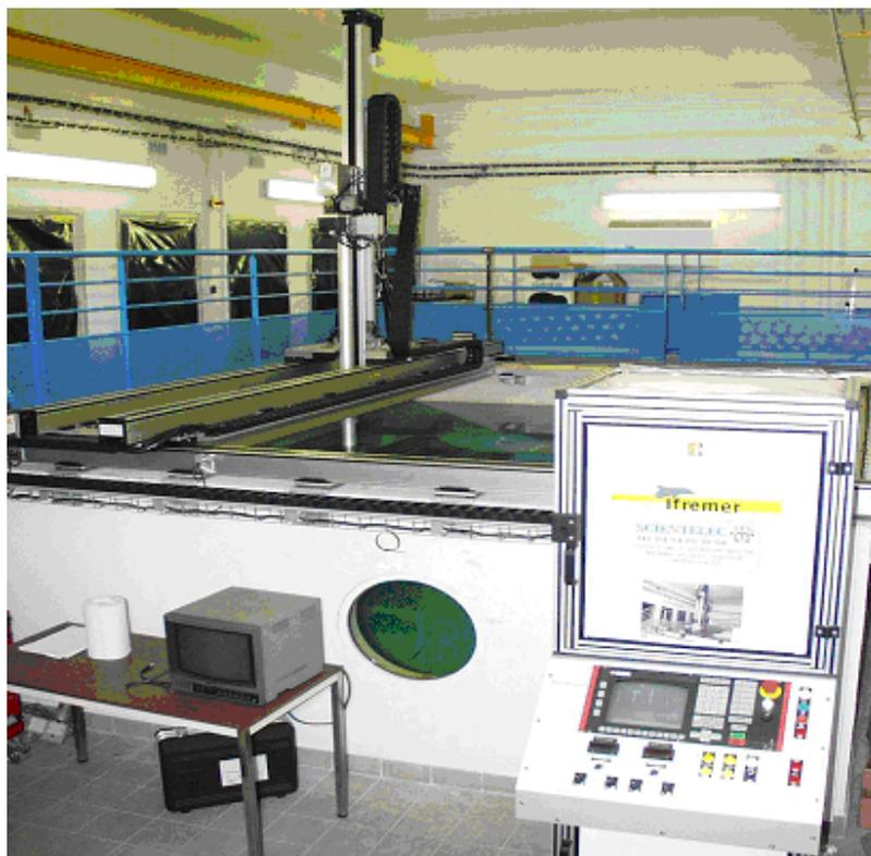
FIG. 5.10 – Le portique PISCATOR sur le bassin d'essai.
