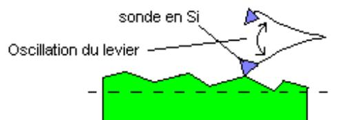
Figure 133 : Représentation schématique mode tapping
