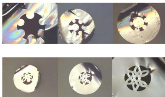
Figure 2.3 : Etapes chronologiques des premiers mètres de fibrage d'une fibre microstructurée.
