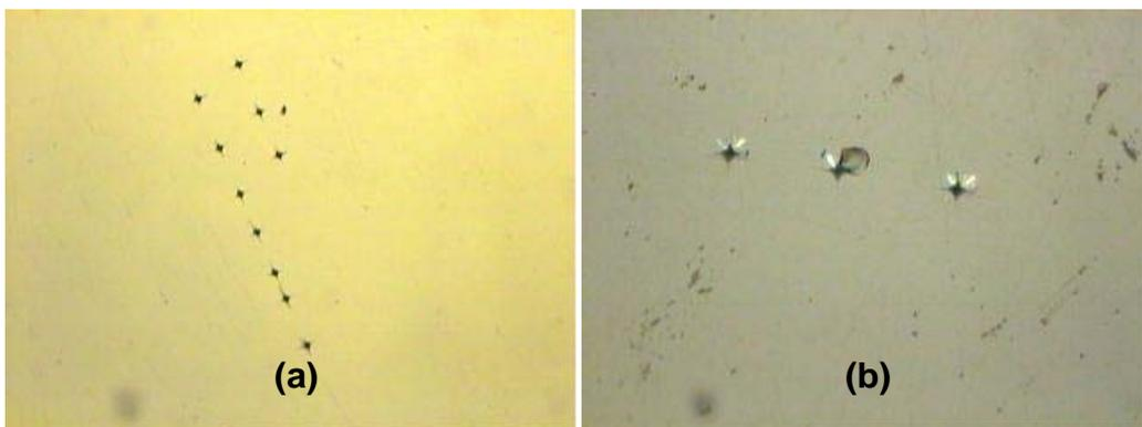
Figure 6.13 : (a) Empreintes d'indentation ( $\approx 15 \mu\text{m}$ ) laissées sur le verre de composition  $70 \text{GeS}_2 - 25 \text{Ga}_2\text{S}_3 - 5 \text{CdCl}_2$  ( $\times 10$ ). (b) Eclatements circulaires ( $\approx 16 \mu\text{m}$ ) pour le verre de composition  $40 \text{GeS}_2 - 25 \text{Ga}_2\text{S}_3 - 35 \text{CdCl}_2$  ( $\times 20$ ).
