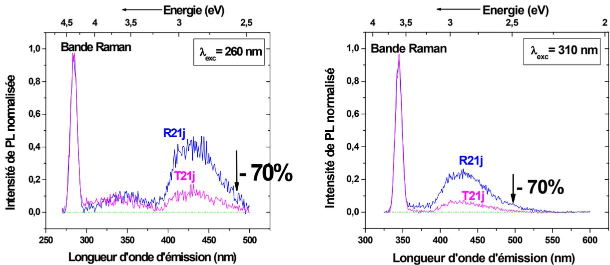
Figure V.4 : Spectres d'émission de Photoluminescence (PL) des échantillons d'eau non dégazés références (R) et exposés aux champs électromagnétiques (T).
