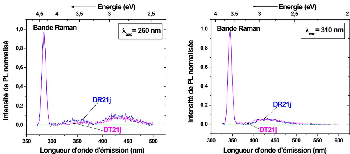
Figure V.5 : Spectres d'émission de Photoluminescence (PL) des échantillons d'eau dégazés références (DR) et exposés aux champs électromagnétiques (DT).
