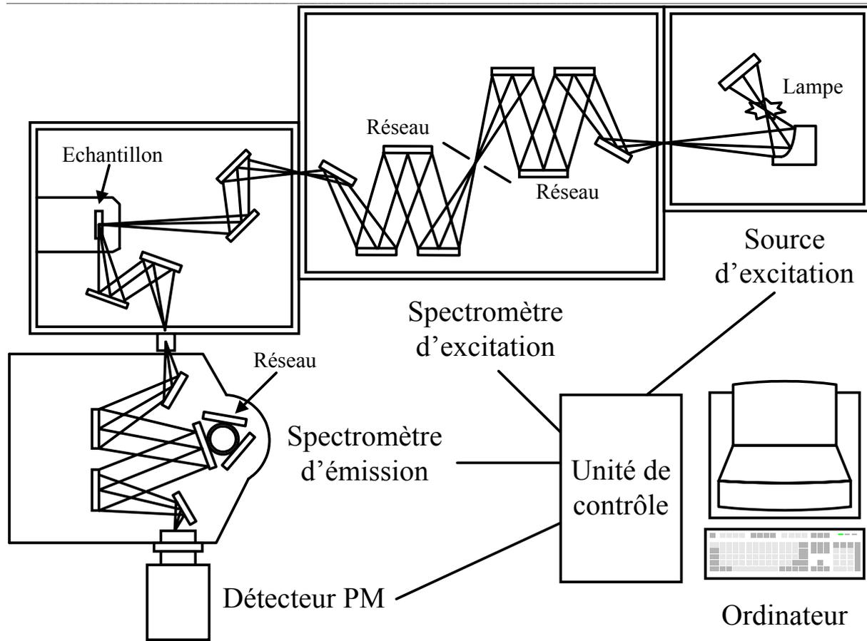
Figure V.1 : Schéma de principe du spectrofluoromètre Fluorolog3-2-Triax utilisé.
