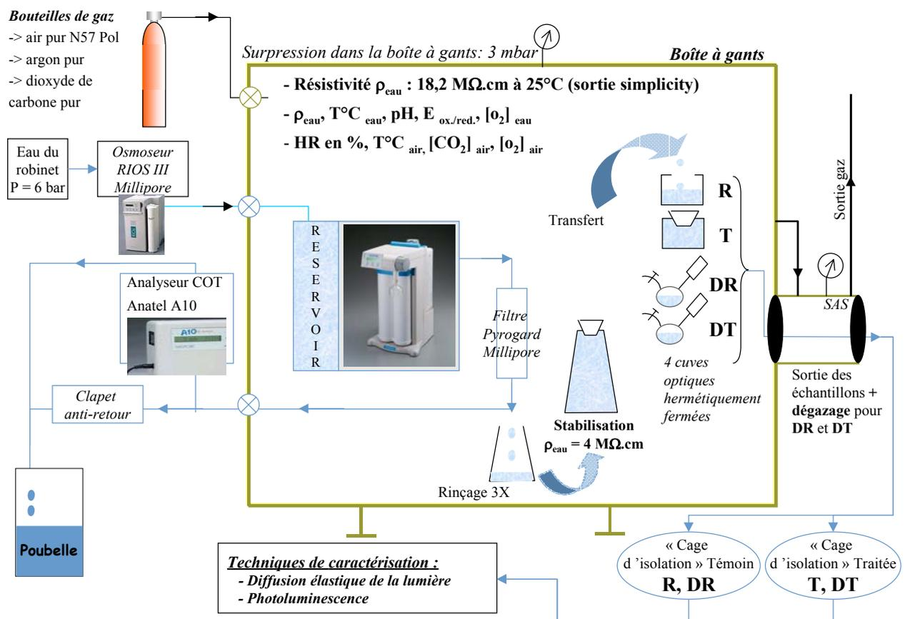
Figure III.8 : protocole de préparation des échantillons d'eau
