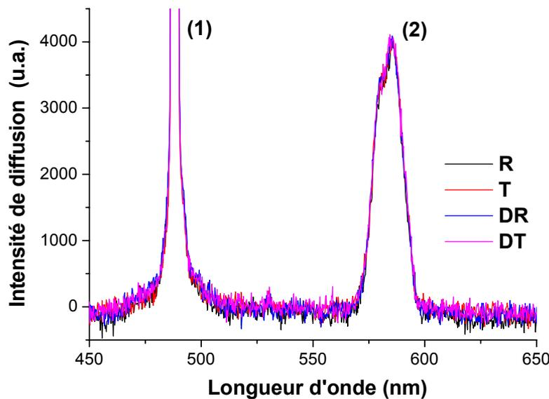
Figure IV.3 : *Spectres de Diffusion élastique et de Diffusion Raman (excité à 488 nm) des échantillons d'eau (R, T, DR, DT). Les pics (1) et (2) correspondent respectivement au pic de diffusion élastique de la lumière et à la bande de diffusion Raman*
