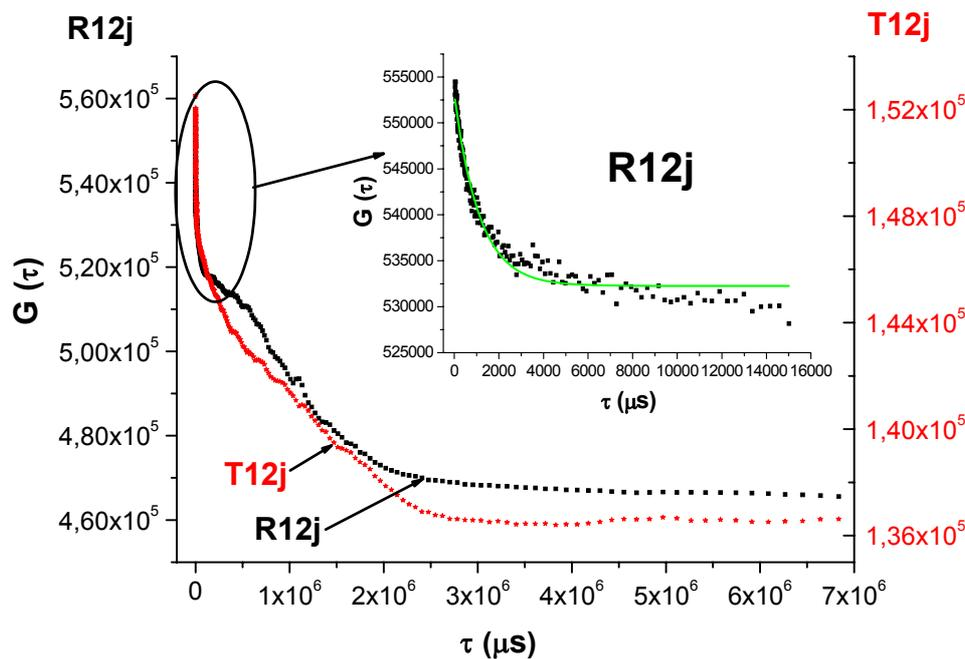
Figure IV.7 : Intensité de la fonction d'autocorrélation  $G(\tau)$  dans les expériences de diffusion dynamique de la lumière des échantillons d'eau référence (R12j) et traité (T12j) au bout de 12 jours en fonction du temps de déclin  $\tau$ . Le graphe inséré montre les plus petits temps de déclin ( $\tau$  compris entre 25 et 15000  $\mu\text{s}$ ) de l'échantillon R12j ; la courbe en vert correspond à un ajustement exponentiel de  $G(\tau)$
