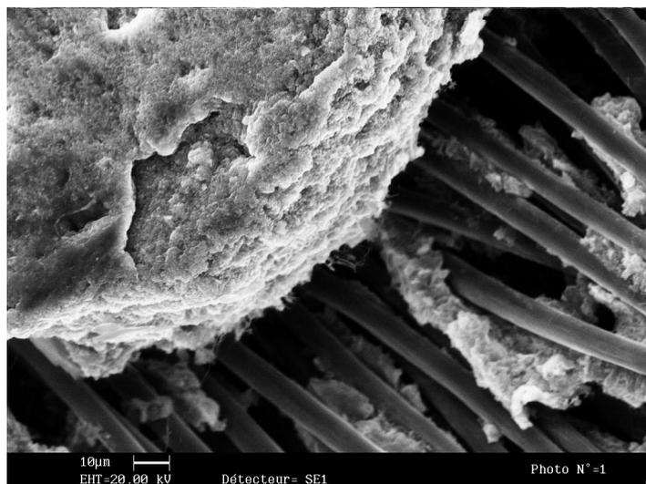
Figure D<sub>6</sub> : Image MEB de l'électrolyte collé sur une électrode.
