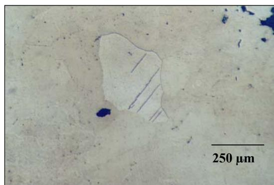
**Figure 5 : Ferrite maclée révélée par attaque Nital, micrographie optique, Caux 01**
