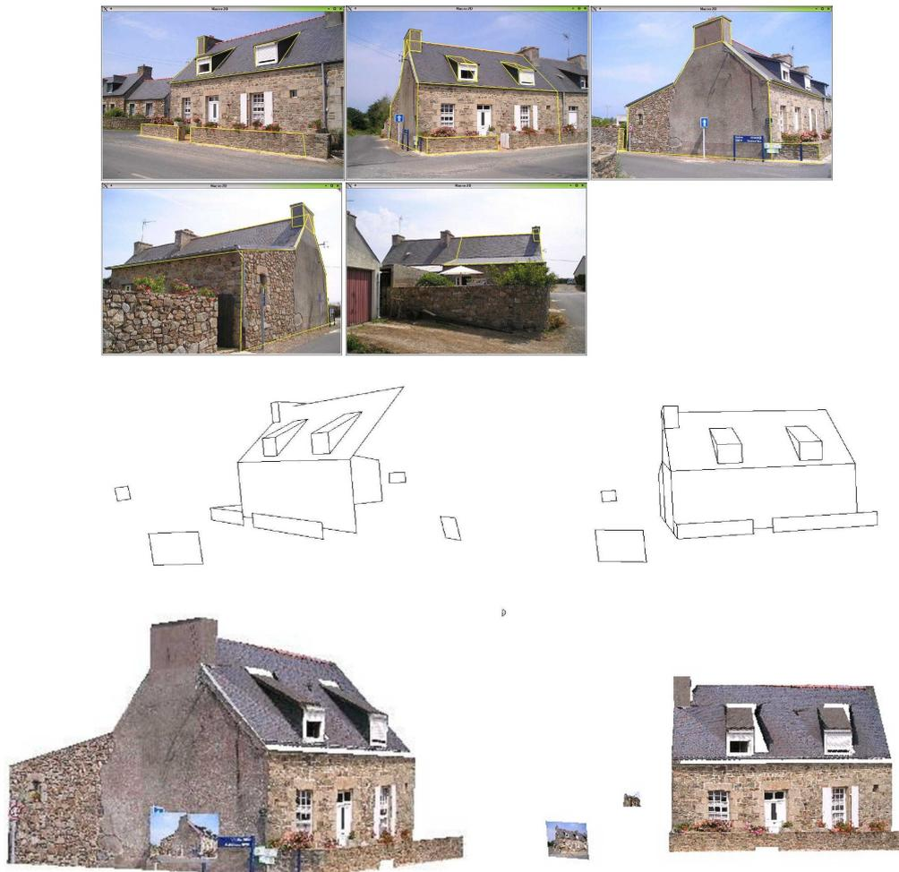
FIG. 5.21: Reconsruction de la maison bretonne. En haut, les images utilisées, au centre, le modèle obtenu rendu en fil de fer et en bas, le modèle final texturé. Dans les images du haut, seul les segments pour lesquels les deux extrémités ont été localisées manuellement dans les images sont représentés.
