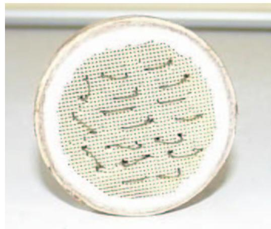
FIG. 1.7 – L'échangeur de chaleur chaud constitué d'un fil de Nichrome enroulé dans une ossature en céramique
