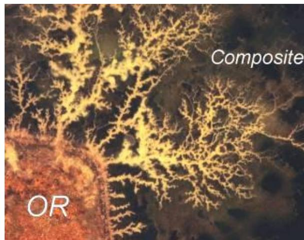
FIG. 5.19 – Dégradation des électrodes et de la couche consécutive à l'application d'un trop fort courant électrique.
