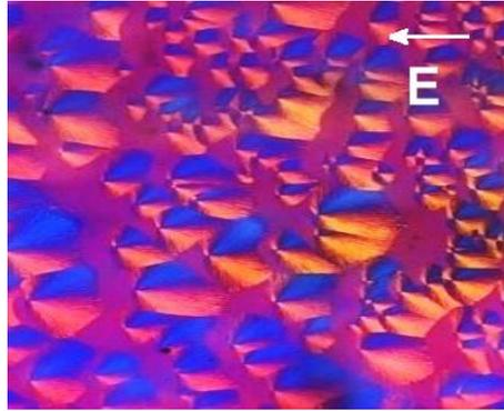
FIG. 5.21 – Image en microscopie en lumière polarisée d'une couche mince dopée à 50% Vol. de  $\text{LiIO}_3$  soumise à un champ électrique dans le plan de la couche pendant la cristallisation
