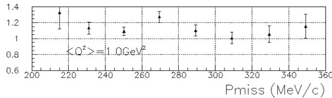
FIG. 6.11 – Rapport des sections efficaces obtenues par la méthode de fit et la méthode traditionnelle, sans soustraction du *continuum*, pour la cinématique avant à  $p_{\text{miss}} = +300 \text{ MeV}/c$  (26).
