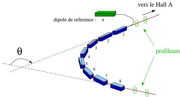
FIG. 2.8 – Principe de mesure de la méthode Arc [57].
