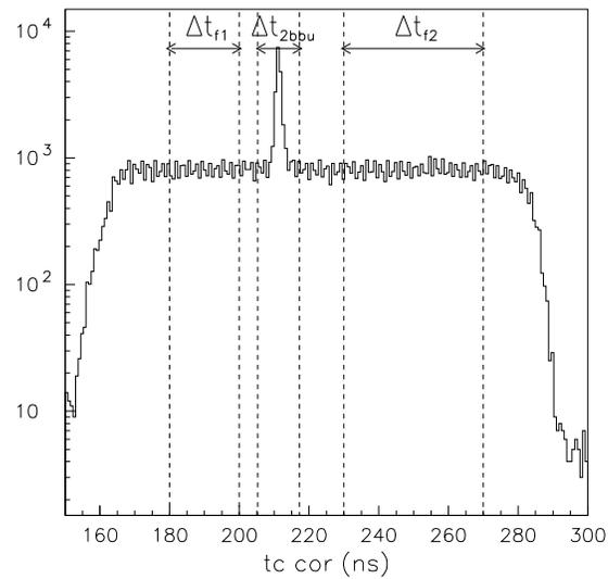
FIG. 5.14 – Définition des fenêtres  $\Delta t_f$  et  $\Delta t_{2bbu}$  de sélection des fortuites et des événements 2bbu sur un spectre en temps de coïncidence  $tc\_cor$  pour la cinématique 22 (après application des coupures de rejet du bruit de fond).
