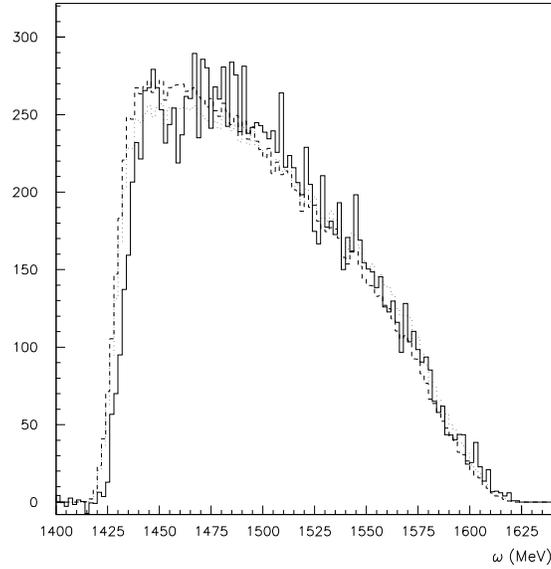
FIG. 6.6 – Spectres en énergie transférée  $\omega$  pour la cinématique 24 ; les données sont en traits pleins, la simulation ajustée à partir du modèle onde plane en tirets et la simulation ajustée à partir d'un modèle unité en pointillés.
