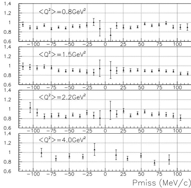
FIG. 6.10 – Rapport des sections efficaces obtenues par la méthode de fit et la méthode traditionnelle, sans soustraction du *continuum*, pour les cinématiques avant à  $p_{\text{miss}} = 0 \text{ MeV}/c$  (16, 01, 18 et 20).
