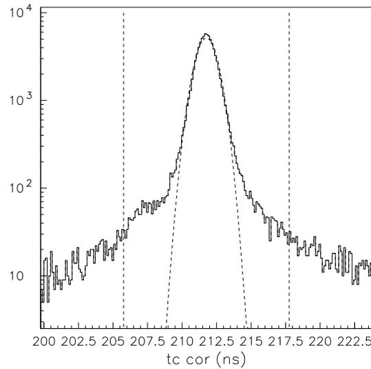
FIG. 5.2 – Définition de la coupure sur le spectre en temps de coïncidence corrigé `tc_cor` pour la cinématique 18 : le fit gaussien permet de juger de la valeur de la résolution ( $\sigma = 0.6$  ns) et de vérifier que la largeur de la fenêtre est suffisante par rapport à cette résolution.
