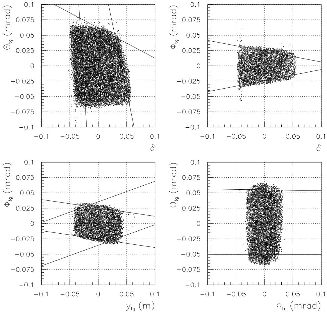
FIG. 5.20 – Représentation des coupures définissant l’espace de phase dans les plans  $(\delta, \theta_{tg})$ ,  $(\delta, \Phi_{tg})$ ,  $(y_{tg}, \Phi_{tg})$  et  $(\Phi_{tg}, \theta_{tg})$  pour le bras hadron (cinématique 01).
