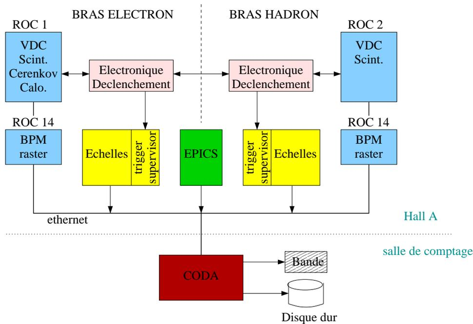
FIG. 2.21 – Schéma de principe du système d'acquisition.
