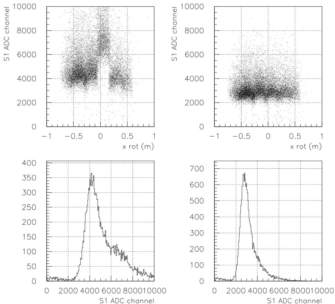
FIG. 3.3 – Energie déposée dans les scintillateurs S1 et S2 du bras hadron (numéro de canal) en fonction de leur position selon  $x$  (coordonnée dispersive le long de laquelle se succèdent les 6 lattes de scintillateur). A gauche : avant calibration ; à droite : après calibration.
