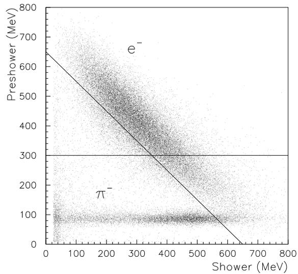
FIG. 4.1 – Sélection des électrons à partir des calorimètres pour le calcul d'efficacité du détecteur Čerenkov : définition des coupures  $\text{preshower} > 300$  MeV et  $\text{preshower} + \text{shower} > 650$  MeV pour la cinématique 19.
