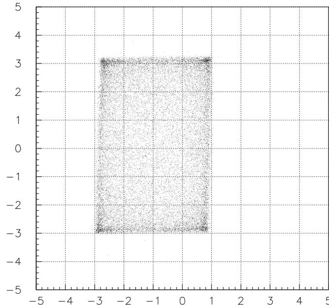
FIG. 2.6 – Distribution spatiale du faisceau à la cible avec le balayage du *raster* (axe Y vertical, axe X horizontal).
