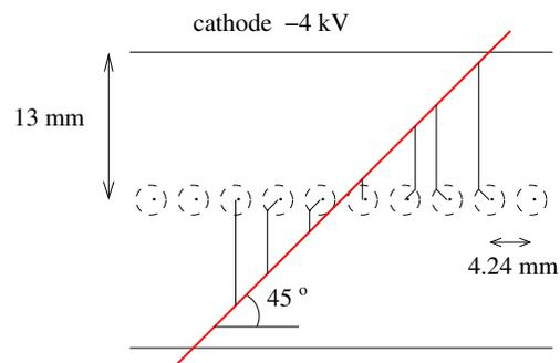
FIG. 2.17 – Schématisation du passage d'une particule dans un plan de chambre à fils.
