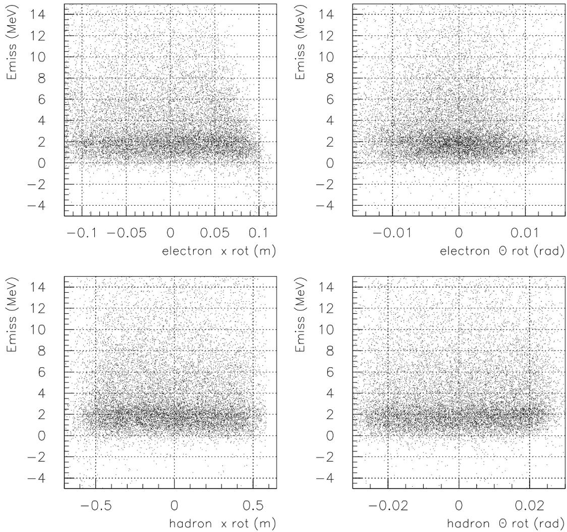
FIG. 3.15 – Distribution de l'énergie manquante  $E_{miss}$  en fonction de la position  $x_{rot}$  et de l'orientation  $\theta_{rot}$  dans le plan dispersif pour les bras électron et hadron : cinématique 16 avec  $P_e=3614$  MeV/c et  $P_h=1005$  MeV/c
