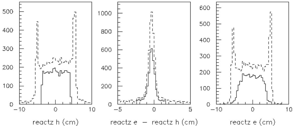
FIG. 5.5 – Spectres des variables `reactz_e`, `reactz_e - reactz_h` et `reactz_h`, avant et après les coupures :  $|\text{reactz}_h| < 4$  cm et  $|\text{reactz}_e - \text{reactz}_h| < 2$  cm pour la cinématique 23.
