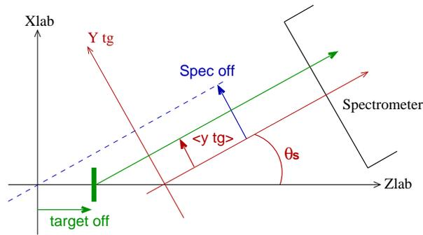
FIG. 3.9 – Définition des variables de *pointing* pour le bras électron.
