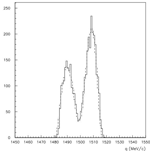
FIG. 6.4 – Spectres en impulsion transférée  $q$  pour la cinématique 03 ; les données sont en traits pleins, la simulation ajustée à partir du modèle onde plane en tirets et la simulation ajustée à partir d'un modèle unité en pointillés.
