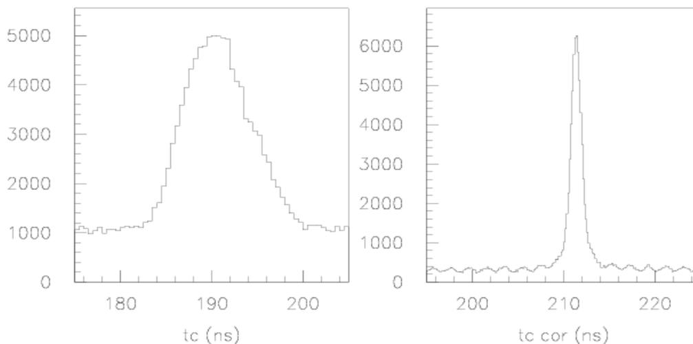
FIG. 5.1 – Spectres du temps de coïncidence brut `tc` et corrigé `tc_cor` pour la cinématique 24. Les corrections de dispersion permettent d'obtenir une résolution de 0.6 ns sur `tc_cor` à partir du spectre brut `tc` présentant une résolution de 3.7 ns : cette amélioration de la résolution permet aussi de distinguer la structure du faisceau avec des paquets d'électrons distants de 2 ns.
