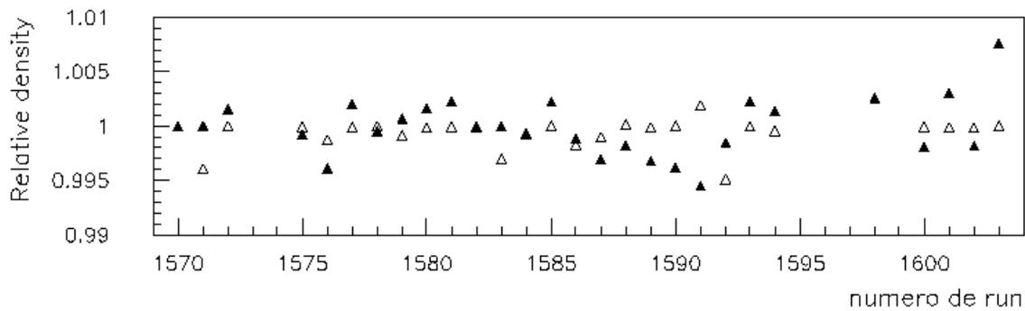
FIG. 4.5 – Densité de la cible pour les *runs* de la cinématique 26, divisée par la densité du premier *run* obtenue par les capteurs de température et de pression. Les triangles noirs représentent la densité relative issue du contrôle des taux en simples du bras électron, les triangles ouverts représentent la densité obtenue à partir des capteurs de température et de pression.
