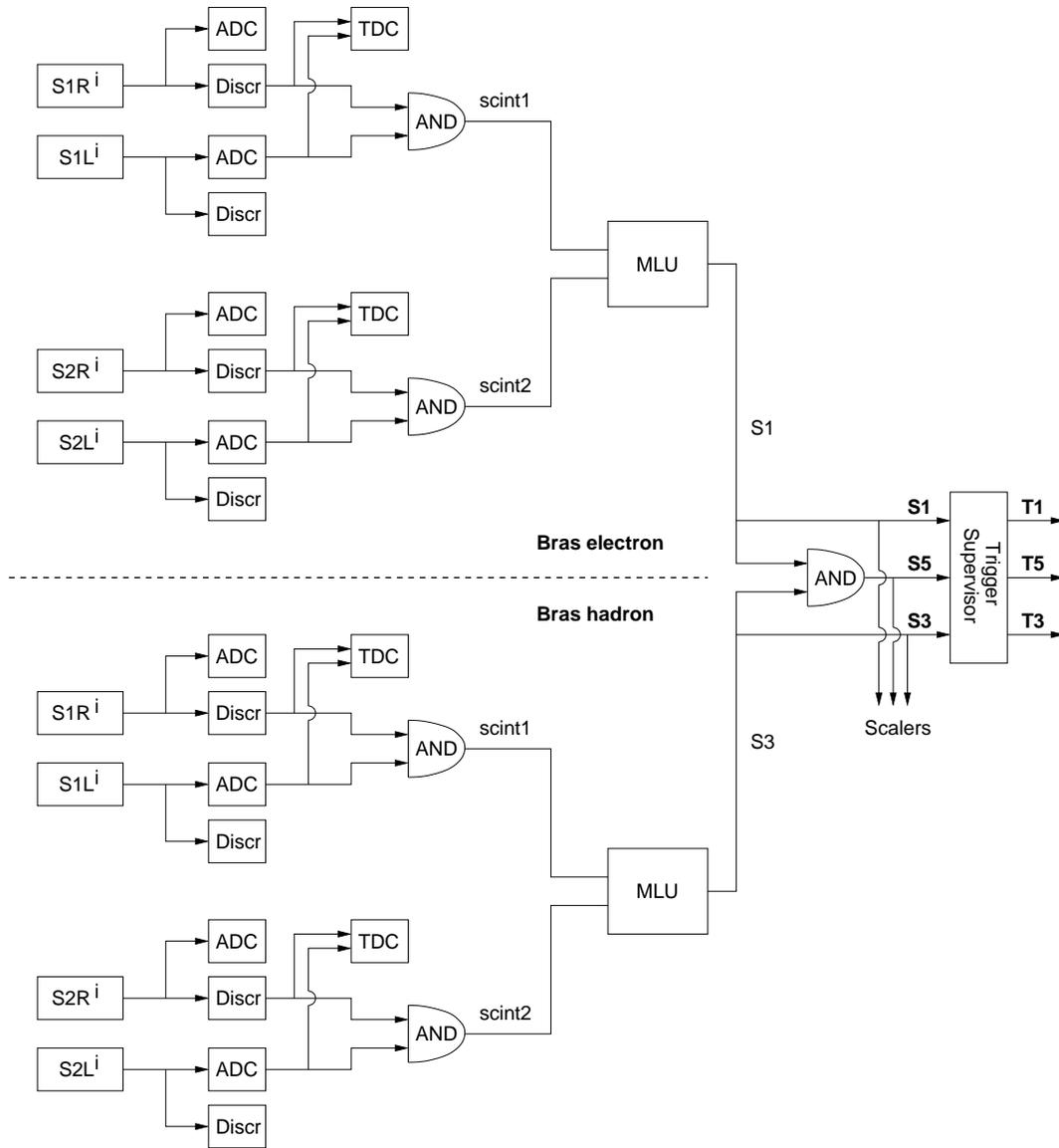
FIG. 2.20 – Principe de déclenchement de l'acquisition et définition des différents *triggers* (les retards ne sont pas représentés) :  $S1R(L)^i$  (resp.  $S2R(L)^i$ ) correspond au photomultiplicateur droit (gauche) du scintillateur  $i$  du plan S1 (resp. S2).
