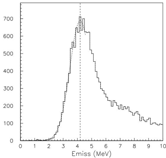
FIG. 5.17 – Ajustement gaussien de l'aile gauche du pic 2-bbu en énergie manquante  $E_{miss}$  pour la cinématique 01 : intervalle en impulsion manquante  $-70 < p_{miss} < -60$  MeV/c.
