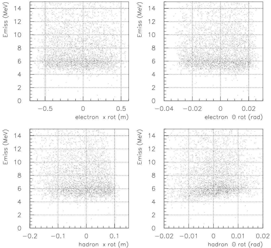
FIG. 3.14 – Distribution de l'énergie manquante  $E_{miss}$  en fonction de la position  $x_{rot}$  et de l'orientation  $\theta_{rot}$  dans le plan dispersif pour les bras électron et hadron : cinématique 21 avec  $P_e=694$  MeV/c et  $P_h=2999$  MeV/c
