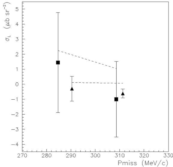
FIG. E.1 – Fonctions de réponses longitudinales pour les cinématiques à  $p_{\text{miss}} = -300$  MeV/c : à  $Q^2 = 0.8$  GeV<sup>2</sup> (carrés noirs) et  $Q^2 = 1.5$  GeV<sup>2</sup> (triangles noirs). Les résultats ponctuels sont comparés aux prédictions théoriques du modèle en ondes planes de De Forest/Salme (tirets) calculées au point cinématique défini par les valeurs moyennes de  $\omega$ ,  $q$  et  $p_{\text{miss}}$ .
