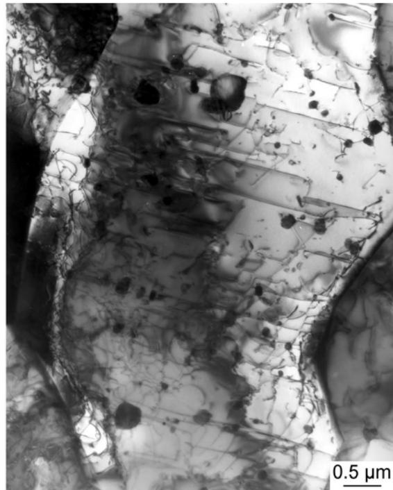
FIG. 2.3 – Vue générale d'un grain après une déformation de 1% ( $M_4$ ).
