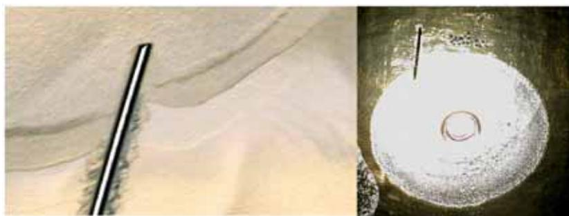
Fig. 11 : Photos prises au cours du développement du biofilm bactérien (*Proteus mirabilis*) en contact avec un morceau de fibre en verre TAS.
