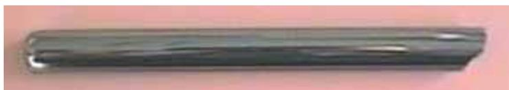
Fig. 4 : Barreau de verre TAS obtenu en fin de synthèse.
