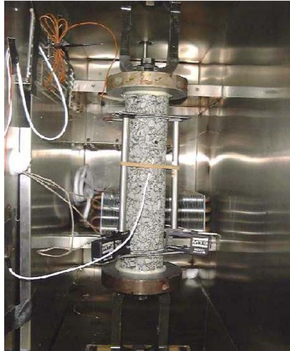
Figure III-13. Montage de l'éprouvette dans l'enceinte MTS.
