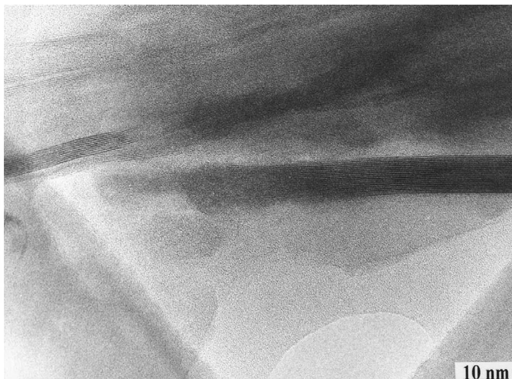
Figure IV.11- MET des CSH-T (C/S=0.9) à 80°C
