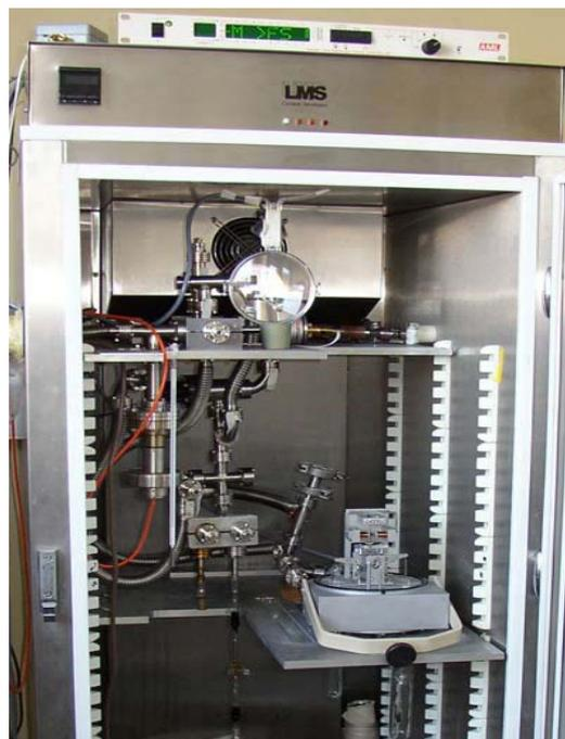
Figure III.27- Appareil d'adsorption en quasi-équilibre
