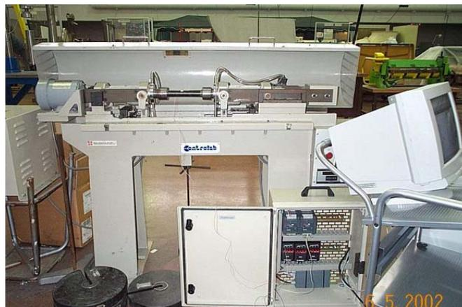
**Figure 80: Machine de flexion rotative**
