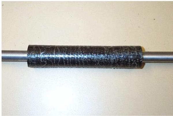
**Figure 79: Epreuve tubulaire avec embouts métalliques**
