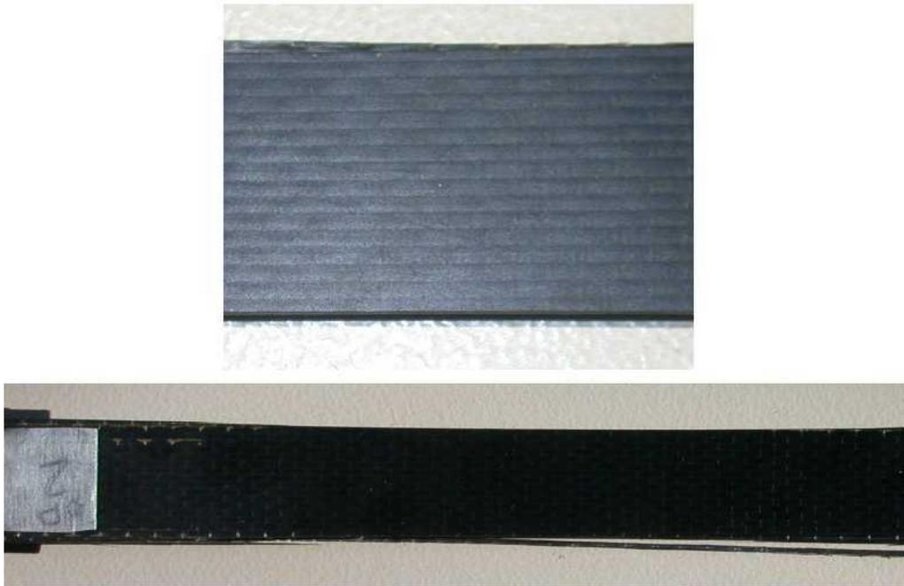
**Figure 58: Photographie de l'éprouvette [0°] après chargement de fatigue**
