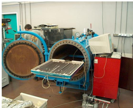
**Figure A83 : Résistance thermique sous la plaque de cuisson**
