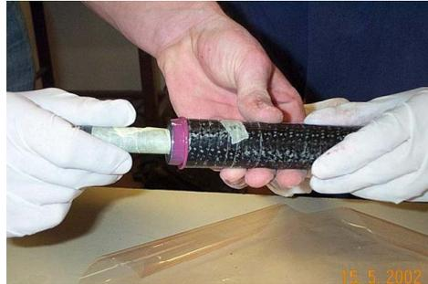
Application sur le tube et pose des embouts
