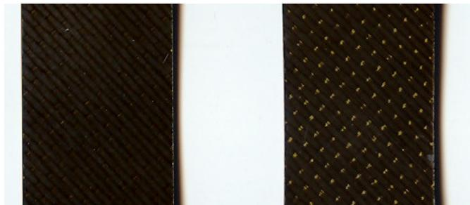
Figure 18: Comparaison d'une éprouvette non sollicitée et d'une éprouvette sollicitée à 4% de déformation totale
