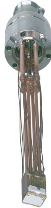
Abbildung 3.3: Der Kupferblock mit dem Chipsubstrat (hier trägt es die Silberspiegelschicht) wird mit Kupferstangen kopffüber gehalten.
