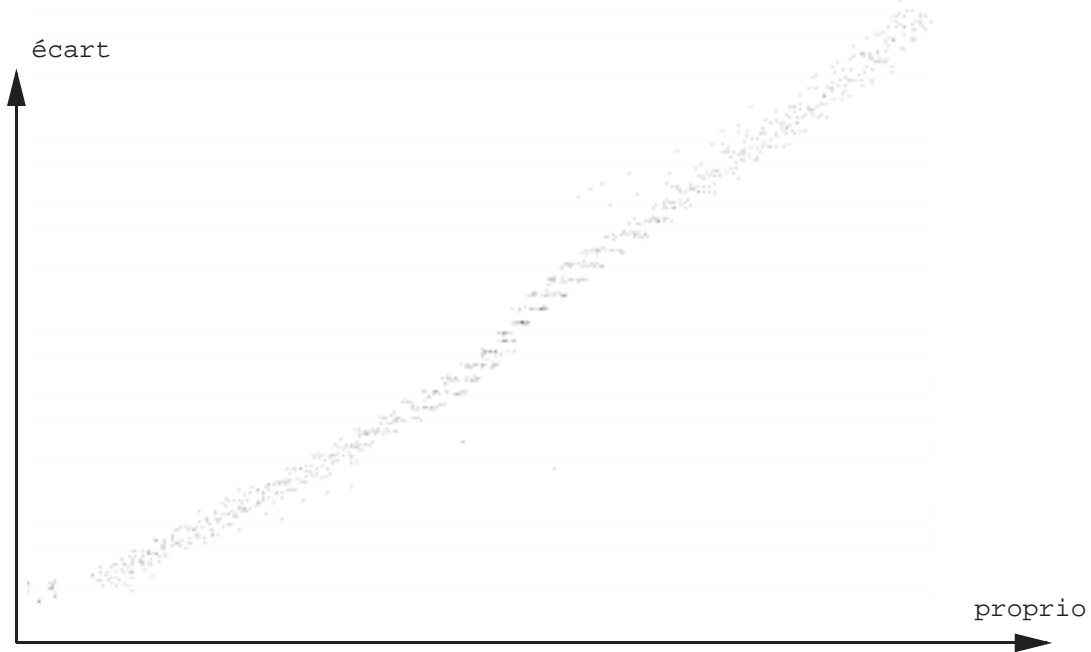
Figure 17. Les mesures de points ( proprio, écart ). Le prétraitement visuel sépare assez bien les mesures du mouvement, ce qui est très étonnant (voir texte). Ces mesures incluent des mouvements latéraux faibles (entre -5 et 5 cm), qui contribuent à l'incertitude sur le traitement visuel.
