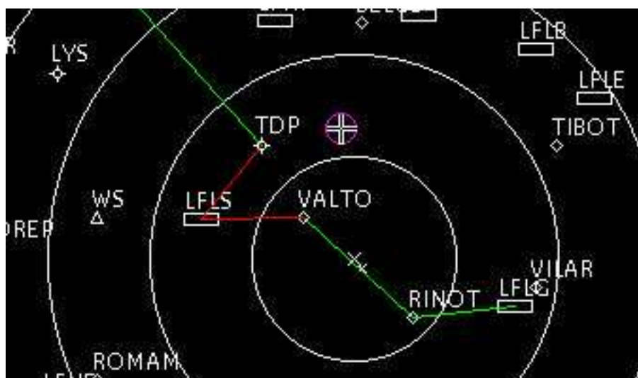
Figure A-8 : Copie d'écran de CoTASS lors d'une alarme proximité du sol.
