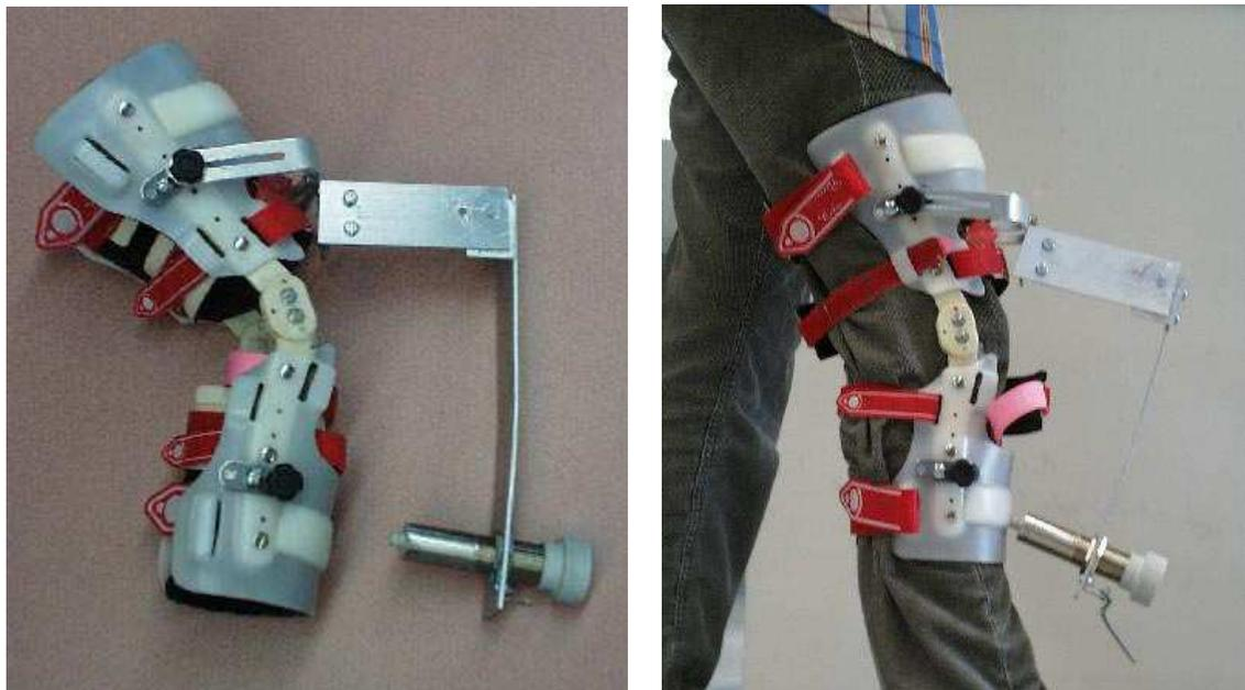
FIG. 6.28: Orthèse du genou utilisée pour les tests.
