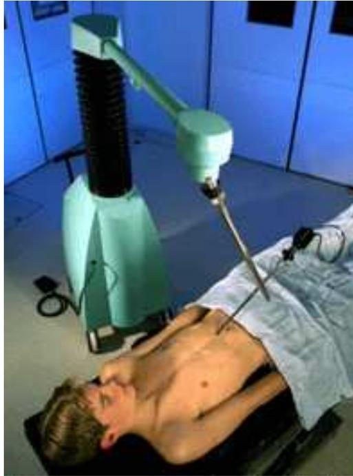
Fig. 1.18: Le robot positionneur d'endoscope EndoAssist [56].
