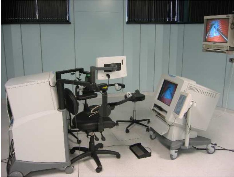
Fig. 1.9: Console de commande du système Zeus. Elle est composée du robot maître et de l'écran vidéo.
