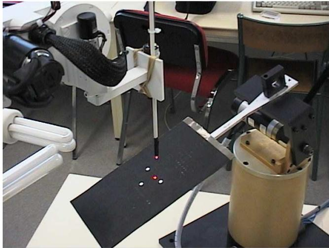
Fig. 6.23: Mini-tourneuse orientable utilisée pour la simulation mécanique d'un mouvement de type cardiaque. La tourneuse déplace une surface marquée de points blancs.
