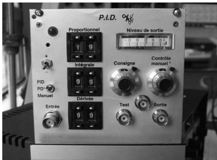
Figure V.3 : vue de la façade du régulateur PID assemblé
