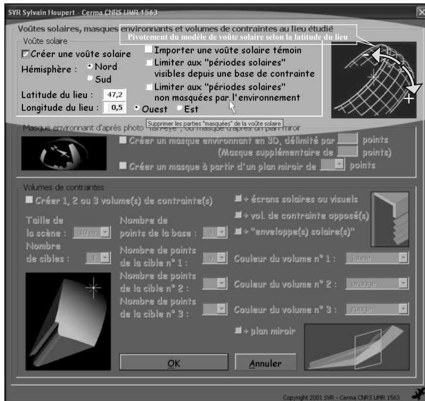
Figure 2-7 : Interface du prototype de logiciel SVR . Dans une première partie, il est demandé au concepteur de rentrer les données suivantes : choix de l'hémisphère (latitude nord ou sud), latitude et longitude de la scène (en degrés), choix de la direction de la longitude (ouest ou est), présence d'un plan de base découpant la voûte solaire (calcul des "périodes solaires visibles uniquement depuis une base de contrainte") et présence de masques dus à l'environnement. Il est aussi proposé au concepteur d'importer depuis une bibliothèque de fichiers, un modèle de voûte solaire supplémentaire, à la manière d'un calque témoin, lui permettant, le cas échéant, de vérifier certaines données effacées par la "limitation" du premier modèle.
