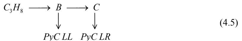
Le pyrocarbone laminaire lisse (PyC LL) est formé aux faibles temps de séjour par une ou plusieurs espèces légères de type *B* issues de la décomposition du propane, et le pyrocarbone laminaire rugueux (PyC LR) à des temps de séjour plus élevés par des espèces lourdes de type *C* correspondant à une maturation plus avancée de la phase gazeuse.
