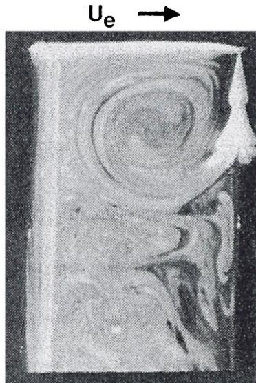
**FIG. 1.9:** Répartition des cellules contrarotatives en cavité profonde [27].
