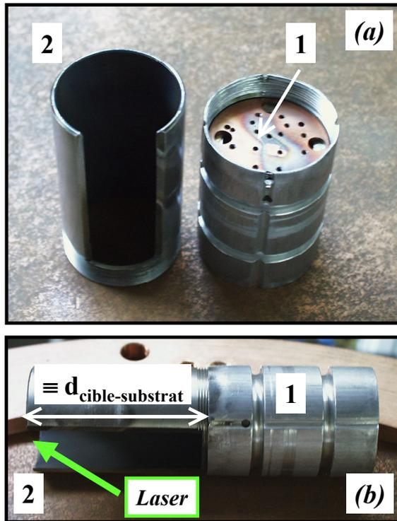
Fig. 6 : Porte-substrat formé de deux parties cylindriques. (a) Plaque (1) permettant de fixer les substrats tel que leur surface soit parallèle à celle de la cible. (b) La distance cible-substrat est déterminé par le cylindre n°2. Une encoche permet le passage du faisceau laser.
