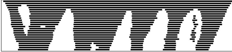
FIG. 3.8 – *Etat du système à débit décroissant, pour  $\Phi = 25$  mm,  $\Delta h = 58$  mm et  $\Gamma = 0,067$  cm<sup>2</sup>/s. Les zones sèches sont assez larges et apparaissent à partir d'une certaine hauteur. Elles s'élargissent assez nettement en allant vers le bas.*
