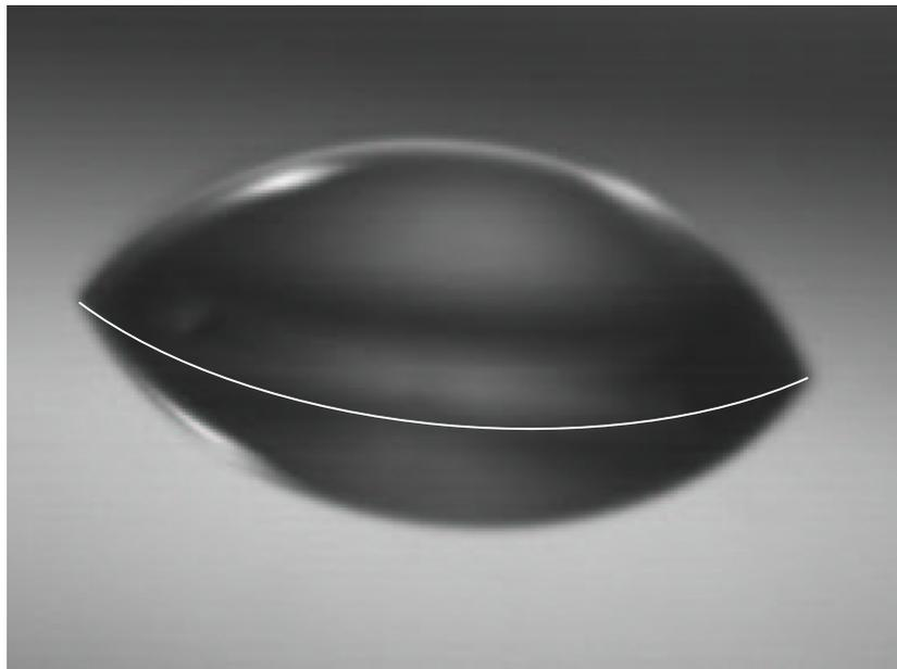
**Fig. 0.1:** Goutte d'eau sur une plaque légèrement inclinée. La photographie a été prise sous incidence rasante, on voit l'image de la goutte et son reflet dans le substrat. La ligne de contact est matérialisée par le trait blanc. Le substrat est un wafer de silicium recouvert de résine pour photolithographie.
