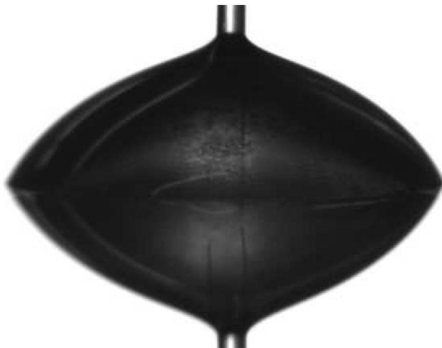
**Fig. A.2:** Goutte d'eau sur le substrat MC1 en train de croître vue sous incidence rasante. L'angle observé est l'angle d'avancée.
