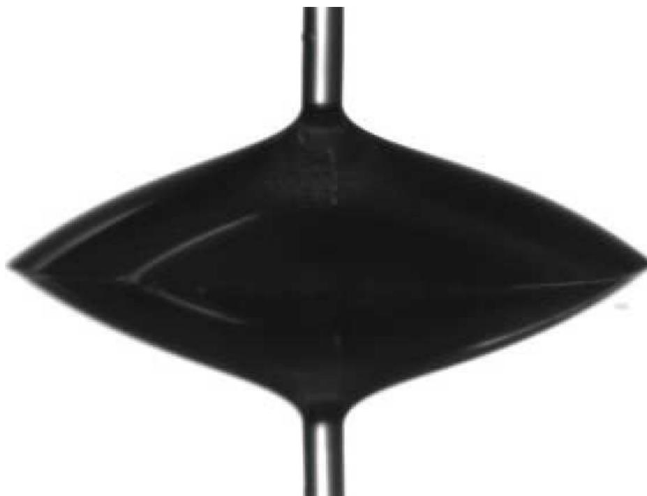
**Fig. A.3:** Goutte d'eau sur le substrat MC1 en train de décroître vue sous incidence rasante. L'angle observé est l'angle de recul.
