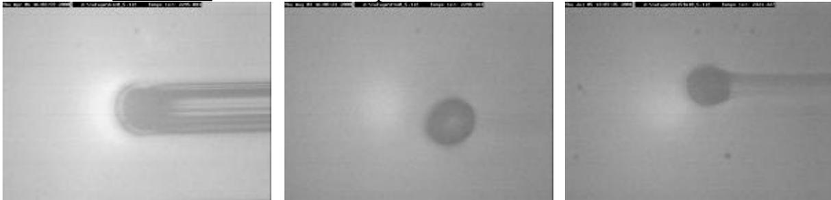
Figure 7.26 : comparaison entre la réponse d'un CR39 nu à gauche, d'un CR39 revêtu d'un vernis de 5 microns P2 au milieu et d'un vernis de 5 microns sans traitement plasma à droite.
