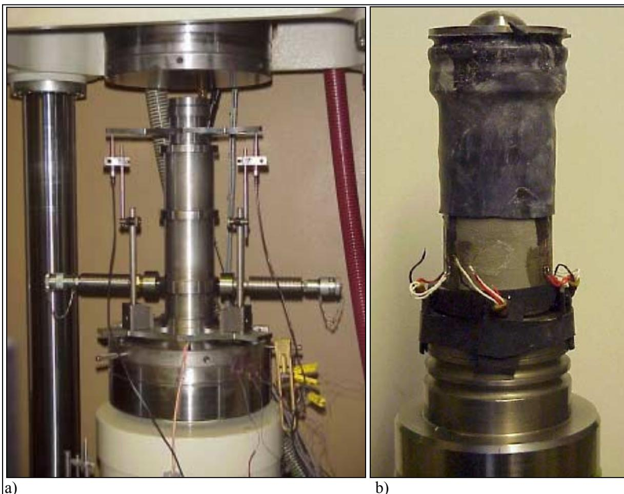
**Figure 6.3 :** Presse Schenck : a) vue sur le plateau instrumenté supportant une cellule de Boehler, b) éprouvette sur l'embase inférieure de la cellule permettant le passage des fils de jauges
