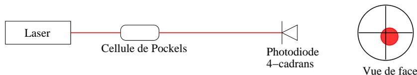
FIG. 2.20 – Schéma du dispositif expérimental mis en œuvre pour tester l'influence de la cellule de Pockels sur la déviation du faisceau laser.
