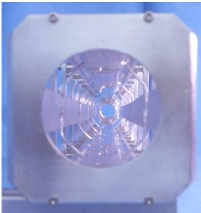
Fig. 5-1 : Doigt de gant et quadripôles  $Q4$
