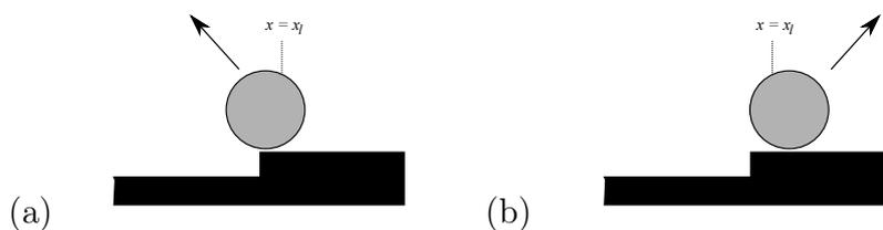
FIGURE B.3 – Deux cas de figure peuvent survenir : (a) si la goutte arrive à gauche de la position limite ( $x < x_l$ ), elle rebondit à gauche ; (b) si elle arrive à droite ( $x > x_l$ ), elle rebondit à droite.
