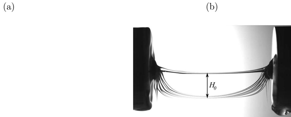
FIGURE 6.2 – Superposition d’images d’un filament d’huile silicone de viscosité 10 Pa.s placé dans le champ de la gravité. (a) La longueur initiale du filament est  $L = 25$  mm et son diamètre  $D = 1,75$  mm. L’intervalle de temps entre deux images consécutives est 0,08 s. (b) La longueur initiale du filament est  $L = 25$  mm et son diamètre  $D = 0,33$  mm. L’intervalle de temps entre deux images consécutives est 0,32 s.
