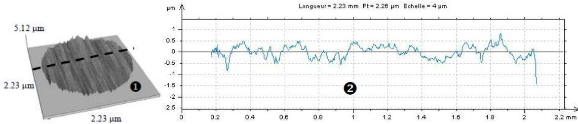
Fig. 2. 50 : Etat de surface du pion avant essai :
