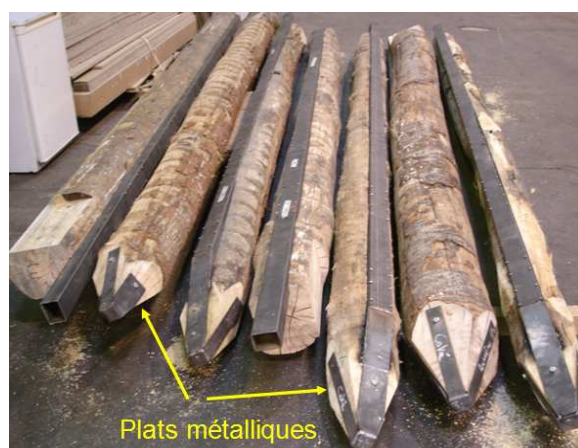
Figure IV-10. Protection de la pointe des pieux en bois avec des plats métalliques
