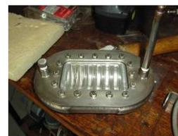
*Figure 31 : Schéma de principe et photo du prototype du dispositif de production quasi instantanée d'eau fraîche et de glaçons développé dans le cadre du partenariat industriel*
