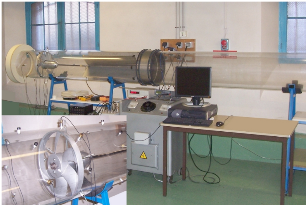
FIGURE 3.2 – Banc BETAECON. Le montage des microphones de fluctuation de pression est illustré en bas à gauche de l'image.
