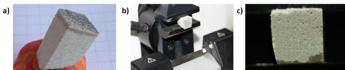
Figure II.6, (a) Exemple d'éprouvette destinée à être microtomée. (b) Eprouvette positionnée dans le MICROTOM HM 360. (c) Image d'une face microtomée (Ech. RO-IT50 à 2500 \mu\text{m} de profondeur).
