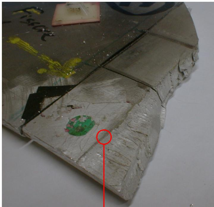
Figure 305 : vue globale de la fissure de la soudure II côté gauche
