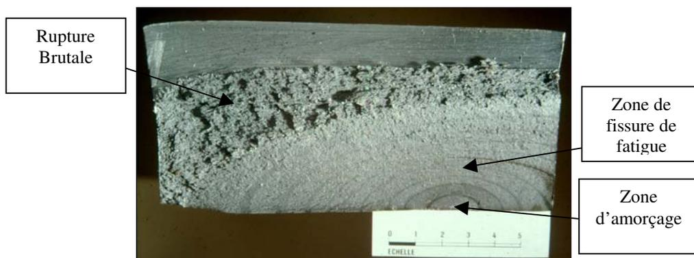
Figure 7 : Faciès de rupture
