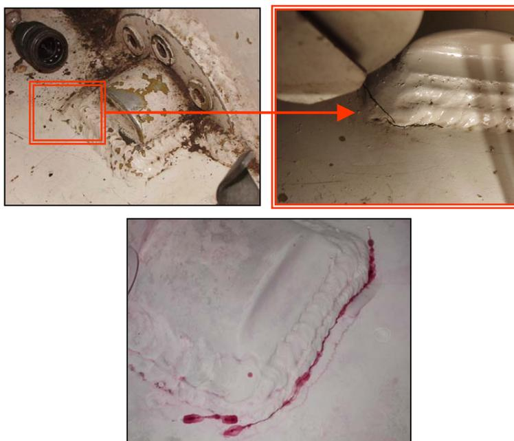
Figure 122 : fissure de fatigue dans une structure mécano-soudée
