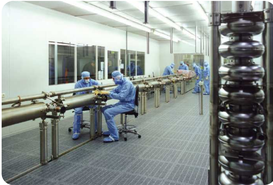
FIGURE 2.10 – Assemblage de cavités supraconductrices en niobium pur pour l'étage d'accélération des électrons. Sur la droite, une cavité attend d'être plongée dans son bain d'hélium. Image tirée de (Schneider et al., 2007).
