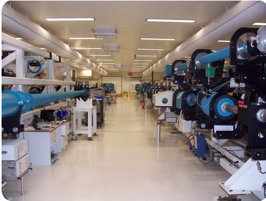
FIGURE 7.2 – Hall où se trouvent les chaînes d’amplification du laser de puissance LULI2000 : trois blocs de 37.5 m de long pour NANO200, PICO2000 et pour quatre autres faisceaux moins énergétiques.
