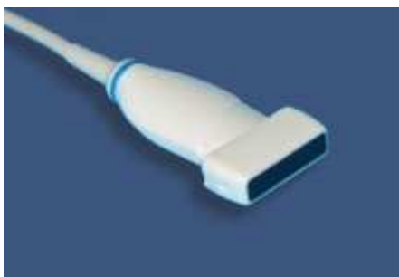
Figure 153 : Sonde Vermon L7-4 (à gauche), Phantom Nuclear Associates Model 84-317 (à droite)
